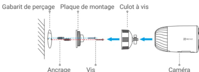
Fig. 2 Montage sur le culot à vis
