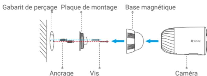
Fig. 1 Montage sur la base magnétique
